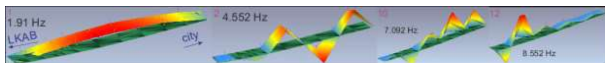
Figur 3.8. Uppmätta frekvenser för moder för oskadad bro och motsvarande beräknade former för moderna 1, 2, 10 och 12, Huang et al (2016).
